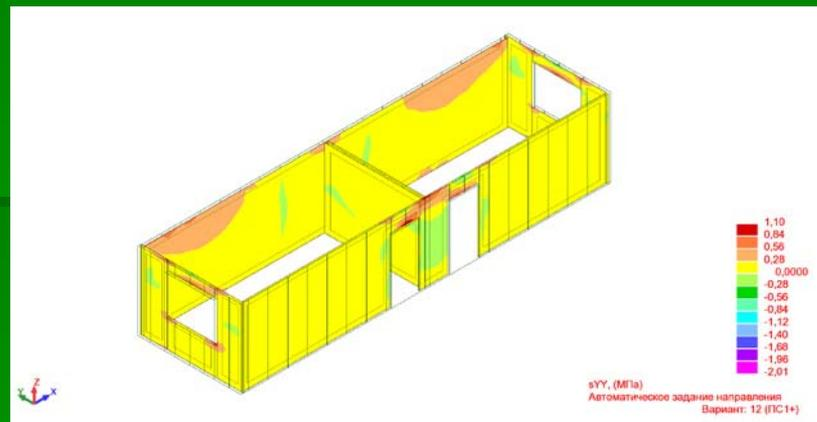
Максимальные вертикальные напряжения  $\sigma_y$  в элементах модуля, кН
