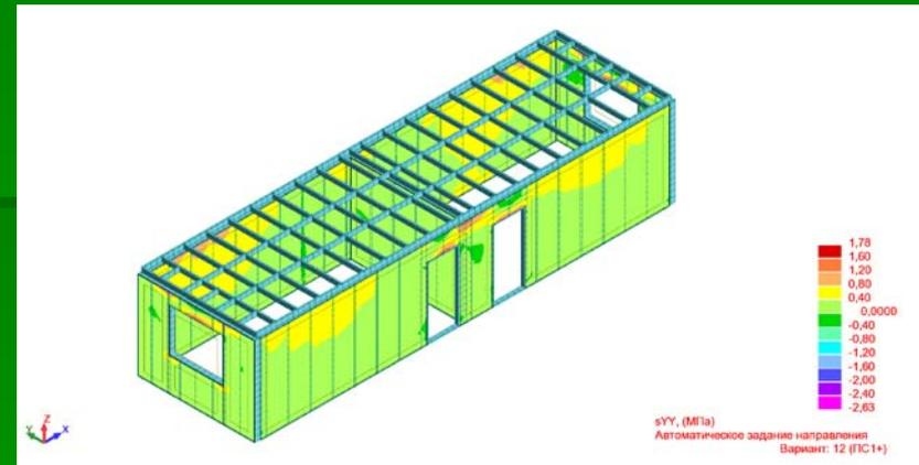
Максимальные вертикальные напряжения  $\sigma_y$  в элементах модуля, кН
