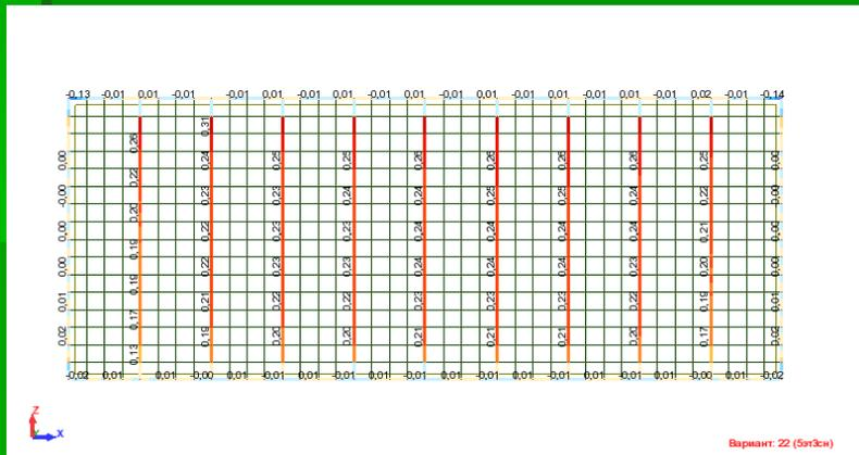
Изгибающие моменты, действующие из плоскости панели  $M_y$  в стержнях расчетной схемы №2, 5 этажей
