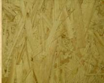
При производстве сэндвич-панелей применяется OSB-3 толщиной 10 и 12 мм.
