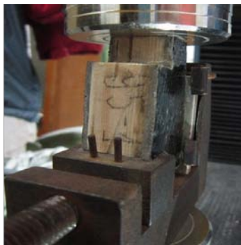
Общие виды испытания опытных образцов на скалывание вдоль волокон
