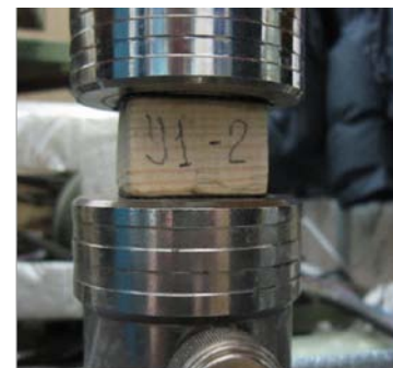
Общие виды испытания опытных образцов на сжатие поперек волокон
